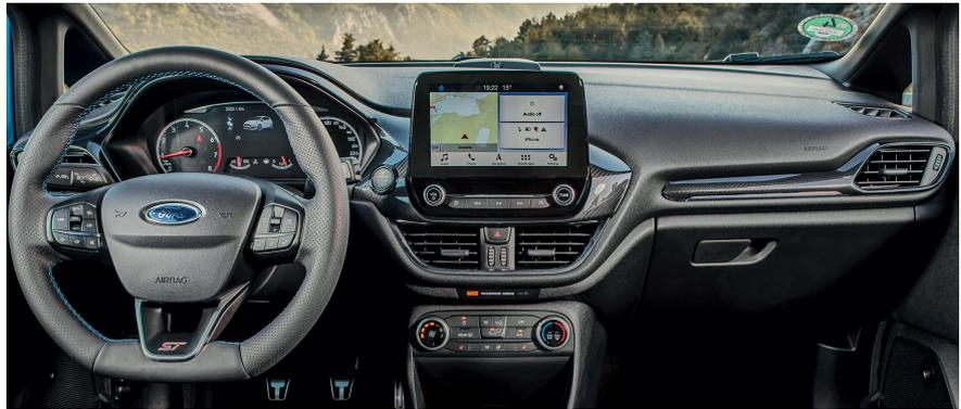
**Bild 1.** Im Cockpit des aktuellen Ford Fiesta befinden sich zwei Zierleisten mit 3D-Oberflächenstruktur: eine über dem Handschuhkastendeckel und eine hinter dem Touchscreen bis zum Ausströmer an der Fahrerseite (© Ford)
