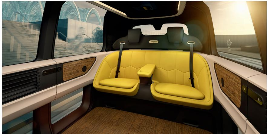
**Bild 4.** Ein Werkstoff, der aus der Rinde der Birke geschält wird, gibt dem Innenraum des Konzeptfahrzeugs „Sedric“ eine umweltfreundliche Anmutung (© VW)
